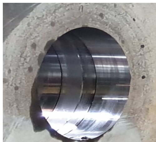
Рис. 5 Порівняння якості обробки отвору «до» (а) впровадження інструменту FF від компанії Іскар та «після» (б)
