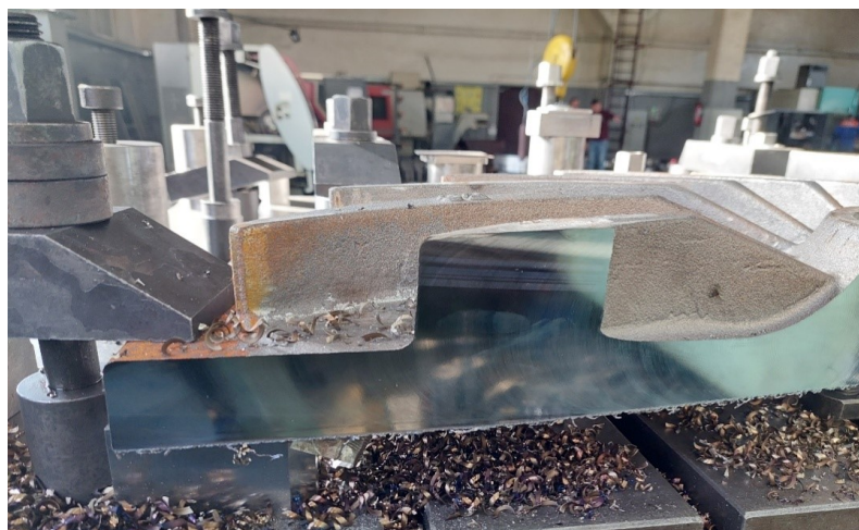
Рис. 3 Обробка великогабаритної деталі «Апарат напрямний»
