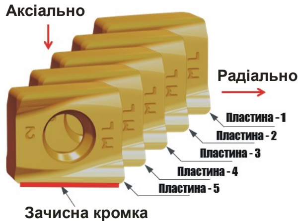
Рис. 2 Розташування пластин на корпусі фрези
