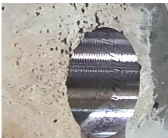
Рис. 5 Порівняння якості обробки отвору «до» (а) впровадження інструменту FF від компанії Іскар та «після» (б)
