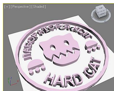
Рис. 4.30. Застосування до малюнка штампа модифікатора Extrude
