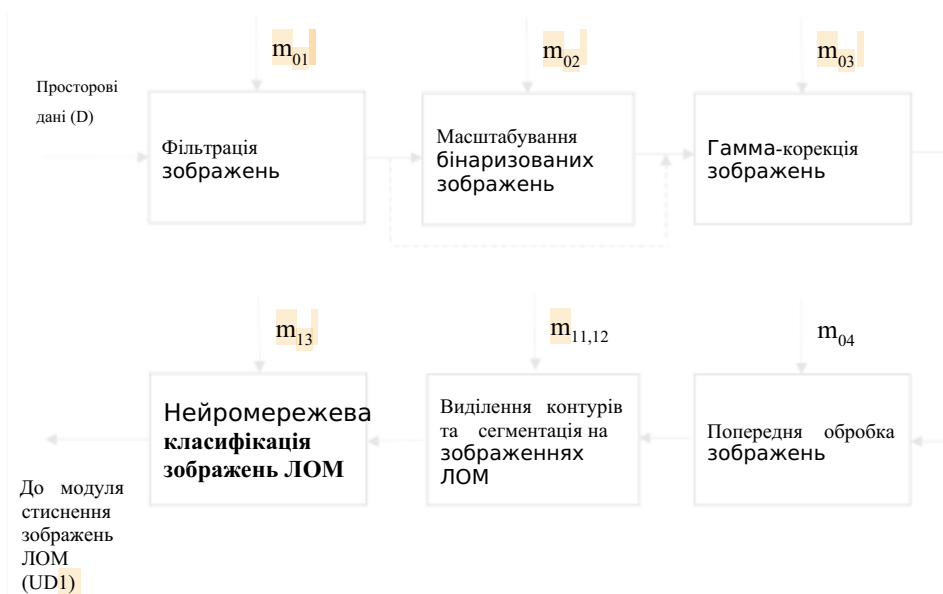
Рисунок 2.5 – Схема ІТ обробки зображень в модулі «Обробка ПД ІСЛЕМ»
