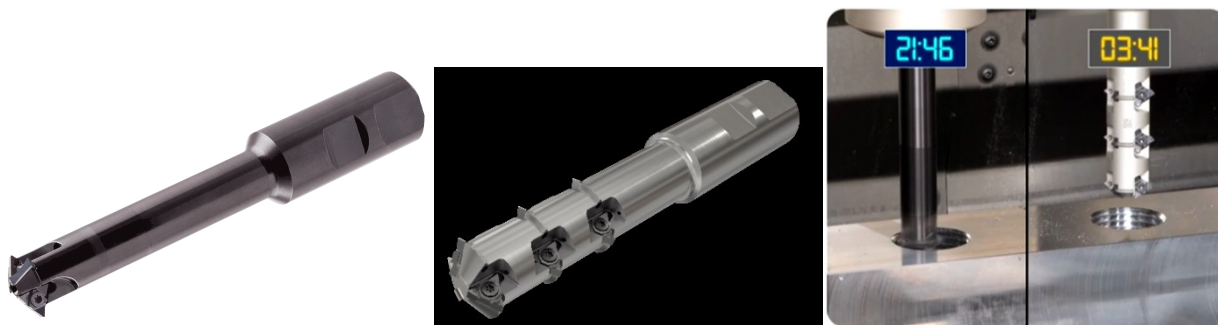
Рис. 5. Порівняння умов обробки стандартною однорядною різьбофрезою з пластинами та багаторядною різьбофрезою з пластинами компанії ISCAR
