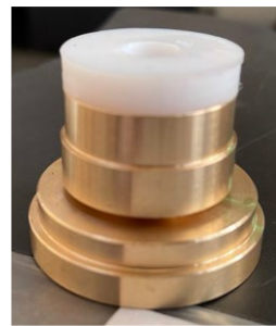
Рисунок 3 – Фільєра макаронна «макарон». Матеріал – тефлон і латунь ЛС59: n=1700 об/хв, S=0,02 мм/об., t=0,2 мм; Ra=0,8 мкм. Обладнання – EX910, TAKISAWA (Тайвань)
