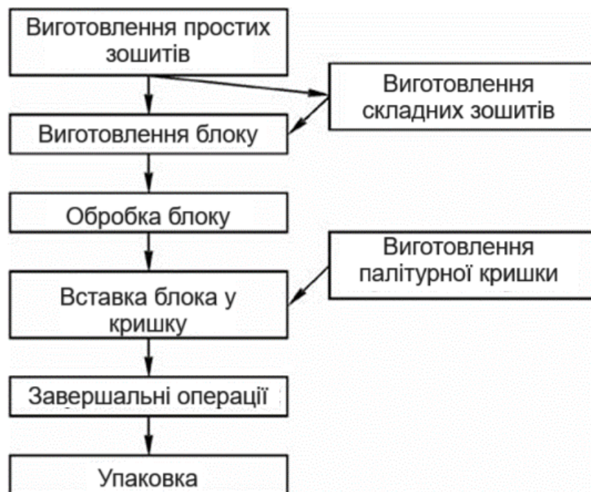
Рисунок 7.2. Укрупнена схема технології брошурувально-палітурних процесів виробництва видань у палітурній кришці
