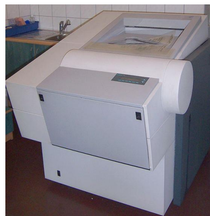
Рисунок 5.14 – Фотонабірний автомат із внутрішнім барабаном
