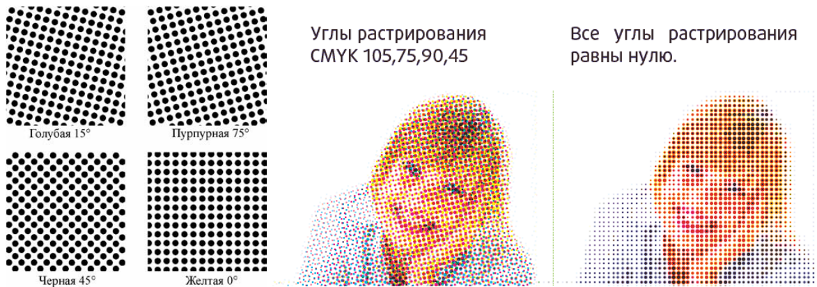
Рисунок 5.17 - Кути нахилу растрів базових кольорів під час друку
