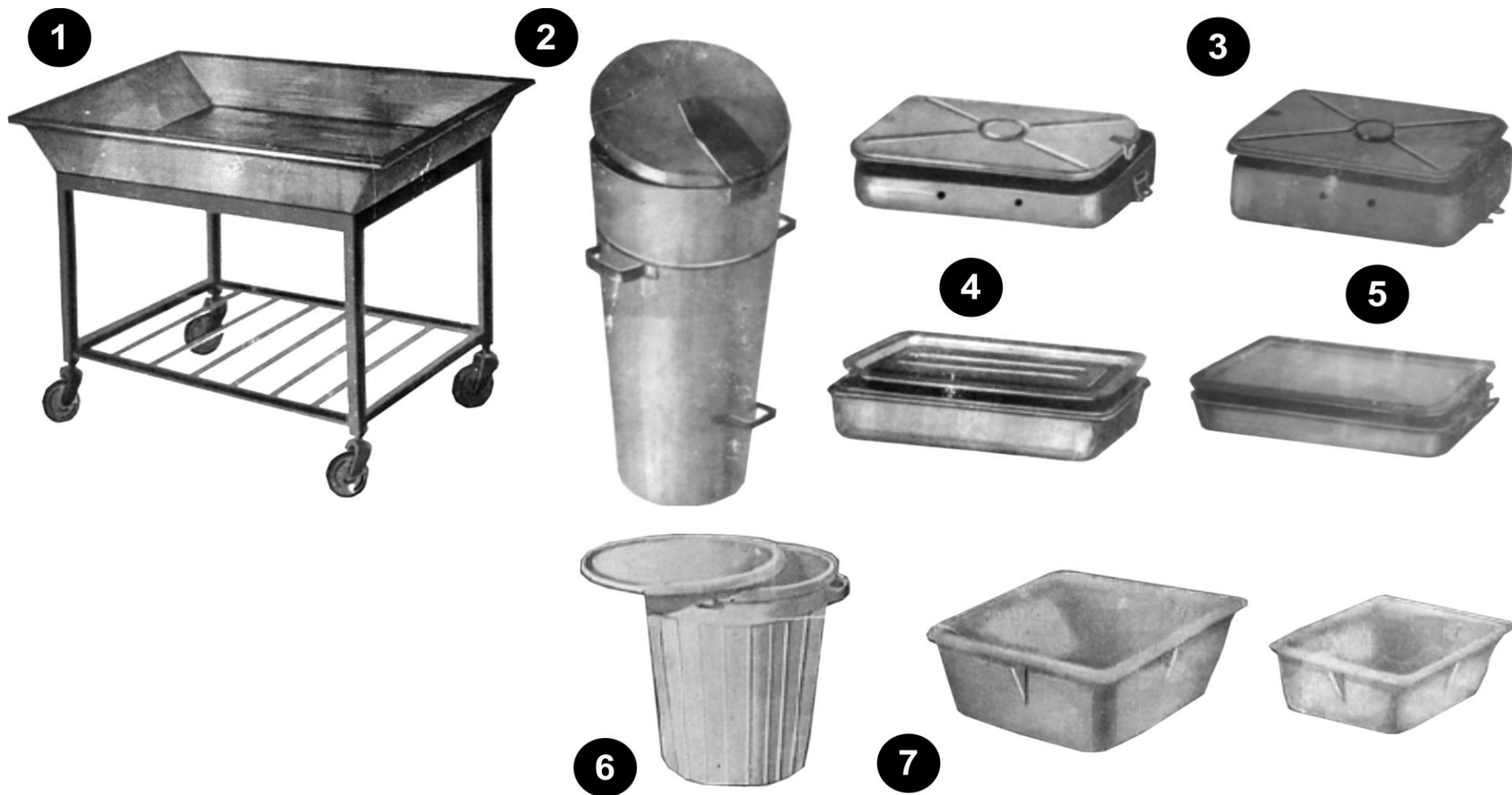
Рисунок Д.2 Тара для м'ясо-рибних цехів: 1 – візок ТМС-75 для перевезення м'яса, риби; 2 – бачок для збирання кісток; 3 – контейнери місткістю 7 і 10 кг для м'ясних і рибних напівфабрикатів; 4 – контейнер універсального типу для м'ясних і рибних напівфабрикатів; 5 – контейнер для рибних напівфабрикатів; 6 – бачок для збирання харчових відходів; 7 – контейнери для напівфабрикатів пластмасові.
