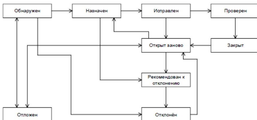
Рисунок 4. 2 - Життєвий цикл звіту про дефект з найбільш типовими переходами між станами
