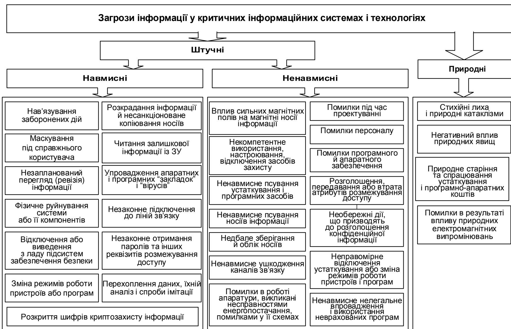
Рис. 1.5. Загрози інформації у критичних інформаційних системах і технологіях
