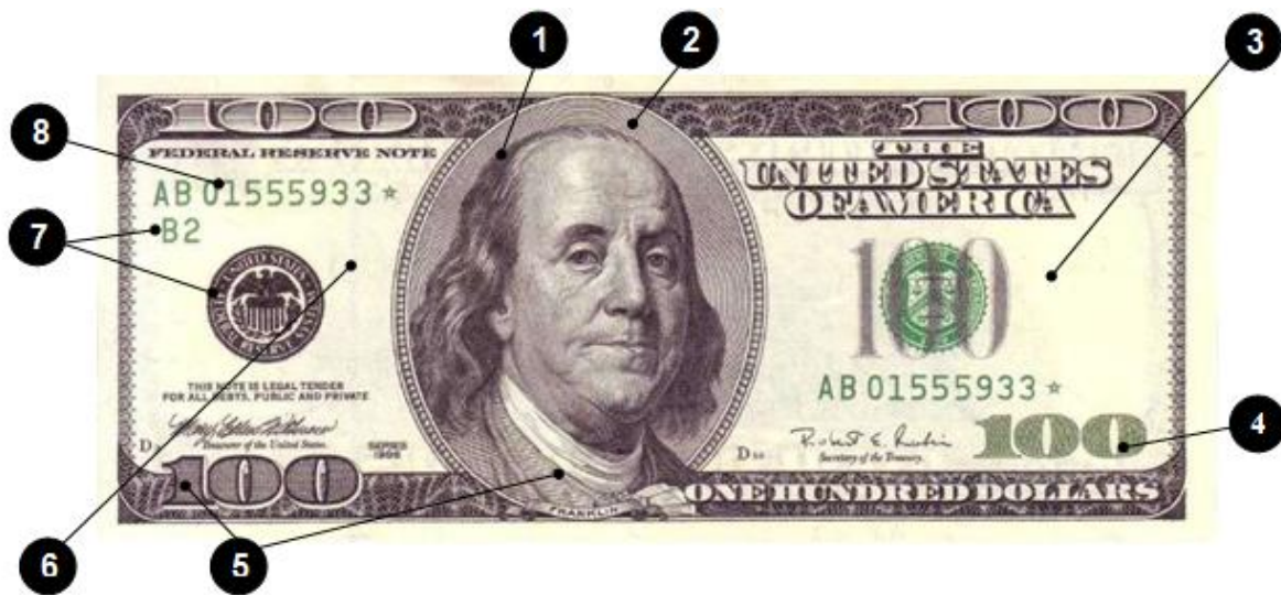
Рисунок 6.5 – Загальний вигляд і розташування захисних елементів американської банкноти номінальною вартістю 100 доларів США (зразок 1996 р. випуску): 1 – портрет; 2 – тонкі концентричні лінії; 3 – водяний знак; 4 – оптично змінна фарба; 5 – мікротекст; 6 – захисна стрічка; 7 – позначки Федеральної резервної системи; 8 – серійний номер
