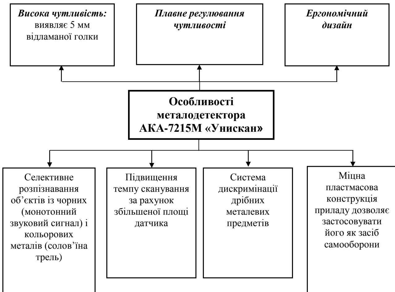
Рисунок 3.11 – Особливості металодетектора АКА-7215М «Унискан»
