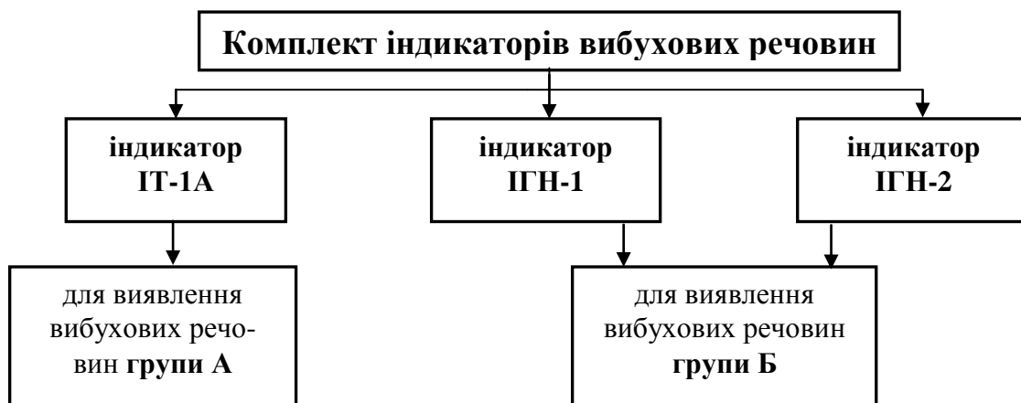
Рисунок 10.9 – Комплект індикаторів вибухових речовин
