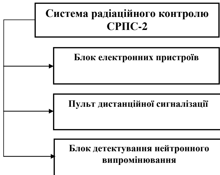
Рисунок 10.7 – Будова системи радіаційного контролю СРПС-2
