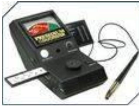
Рисунок 5.8 – Детектор дорогоцінного каміння «Presidium Duotester» (загальний вигляд)
