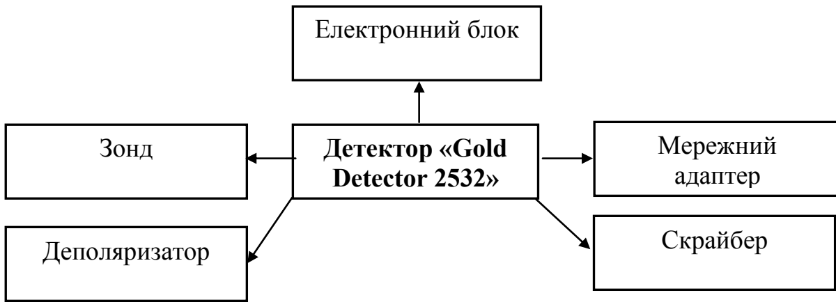
Рисунок 4.9 – Будова детектора «Gold Detector 2532»
