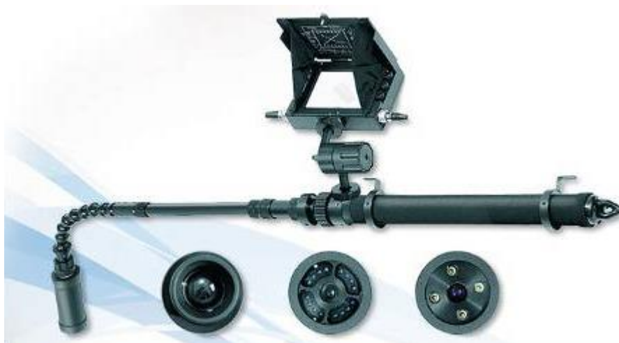
Рисунок 8.22 – Комплект обладнання для дистанційного візуального контролю «СТС І»
