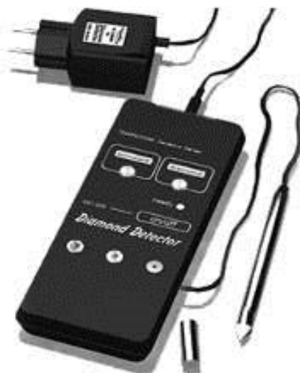
Рисунок 5.7 – Детектор алмазів і діамантів «Diamond Detector DS1326»
